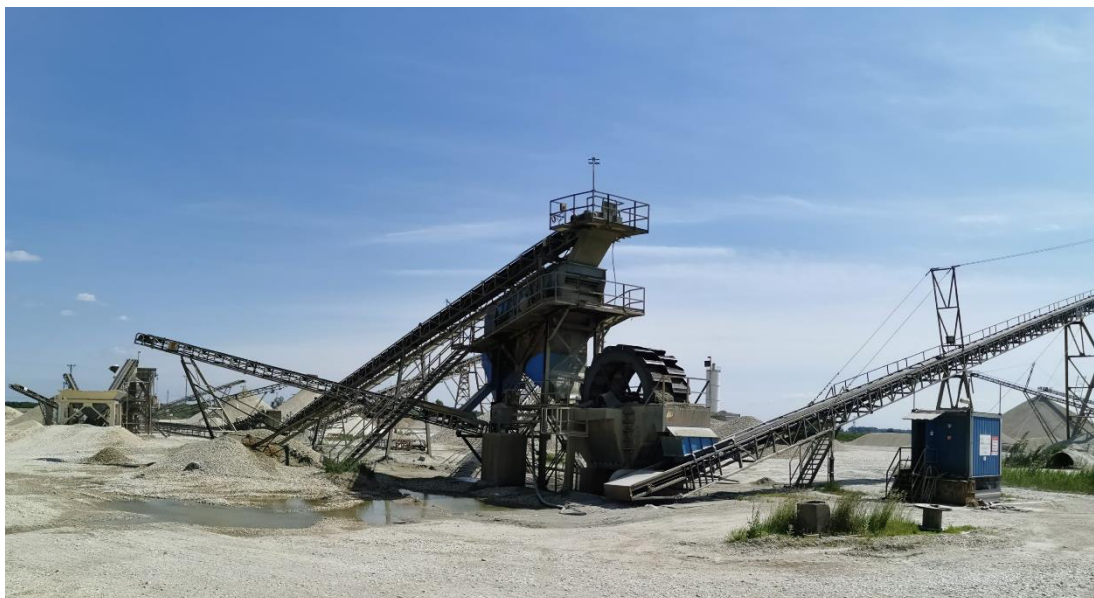
3. kép: Előosztályozó és dehidrátor, háttérben a törőmű (2021.05.28.)
