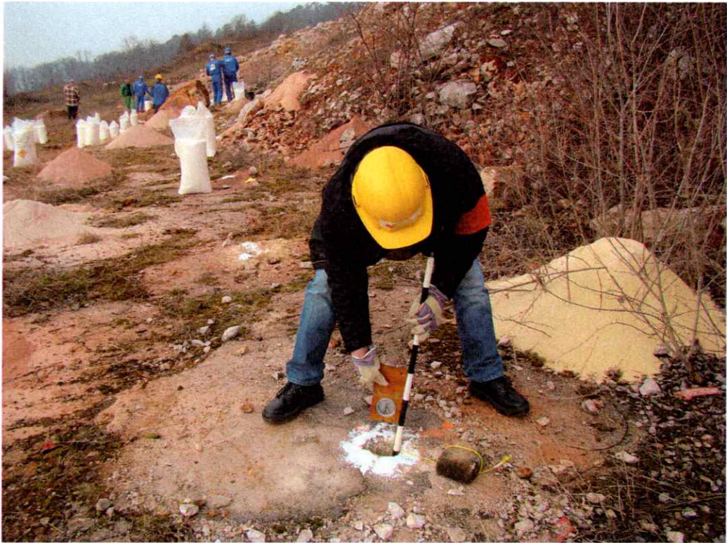
A robbantólyukak dőlésszögének ellenőrzése
