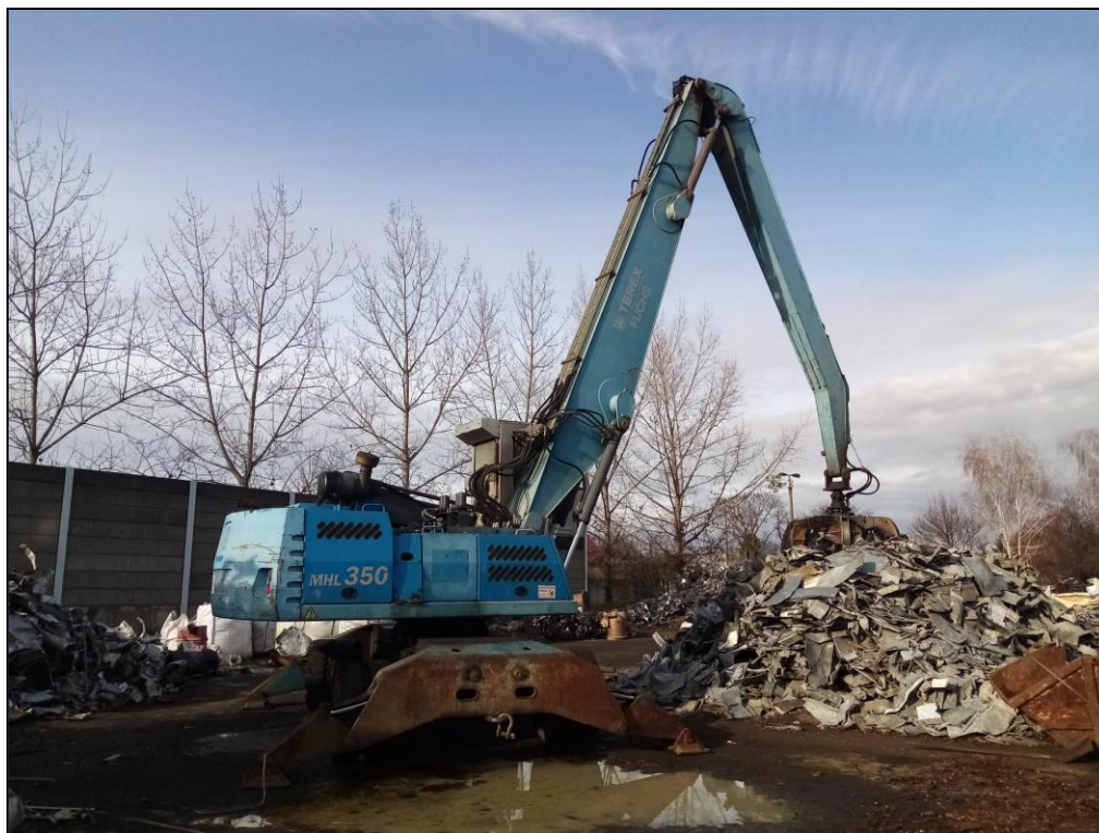
5. ábra: Polipmarkolóval felszerelt rakodógép munka közben
