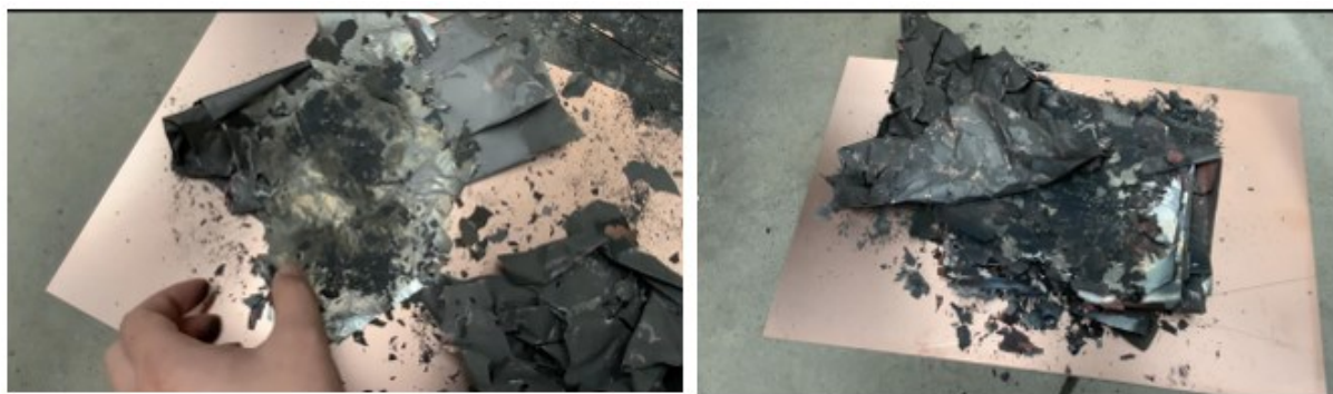
3. ábra Lítium akkumulátor a kalcinálás után
