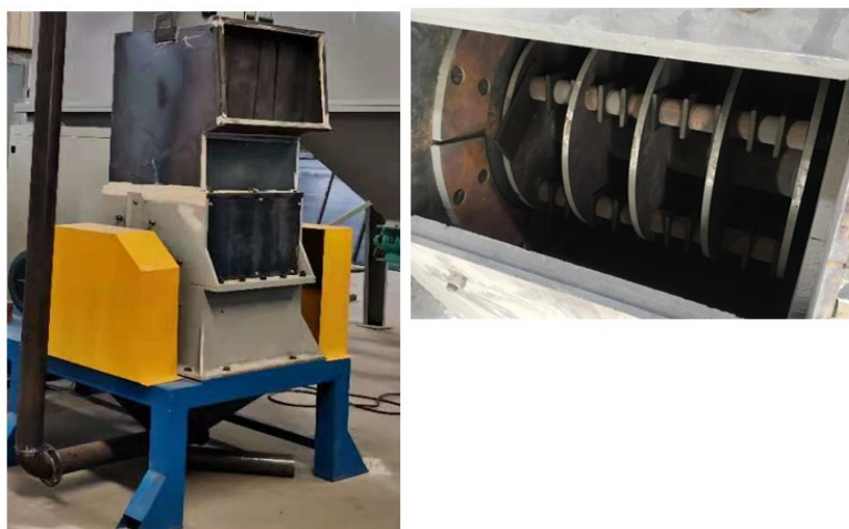
16. ábra Daráló berendezés (másodlagos leválasztás)
