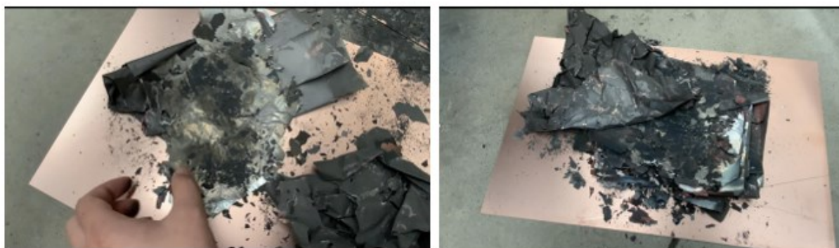
13. ábra Lítium akkumulátor a kalcinálás után
