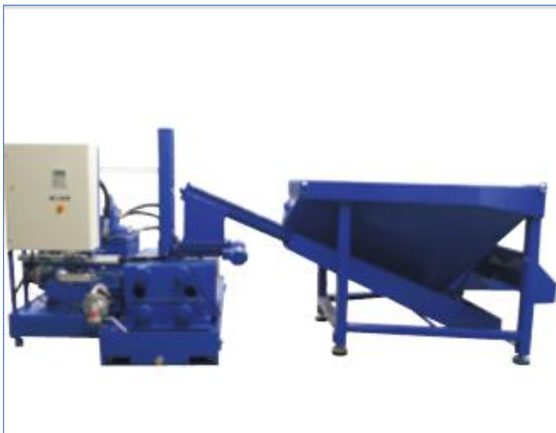
12. ábra RB 30/4000/70 tip. brikettáló (Forrás: Megbízói adatszolgáltatás)
