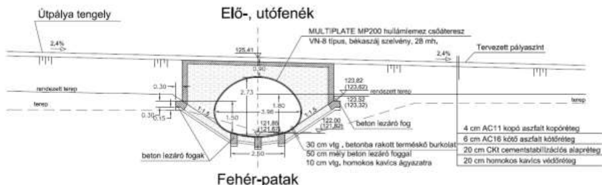
8. ábra: Elő-, utófenék keresztmetszet (Forrás: Hídépítés engedélyes terve)
