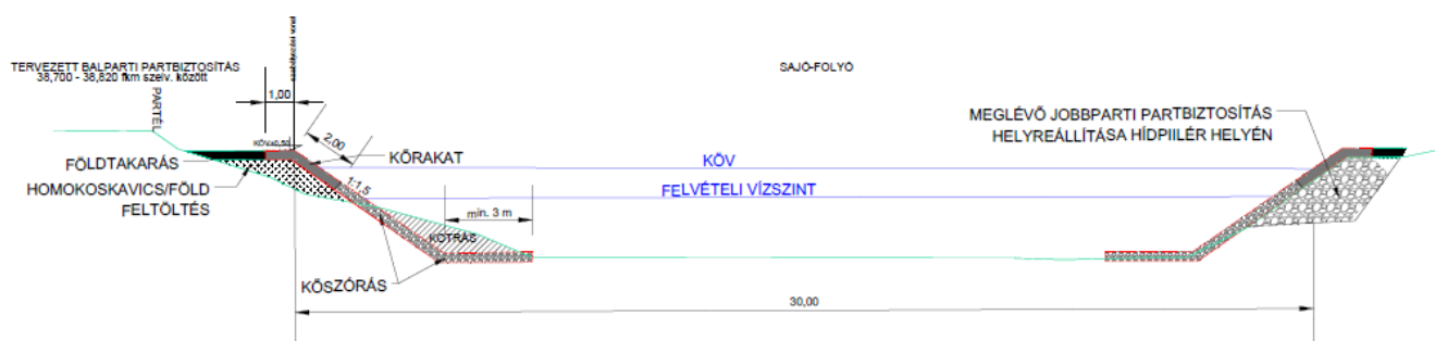
5.5.4. ábra A kőszórás tervezett kialakításának módja
