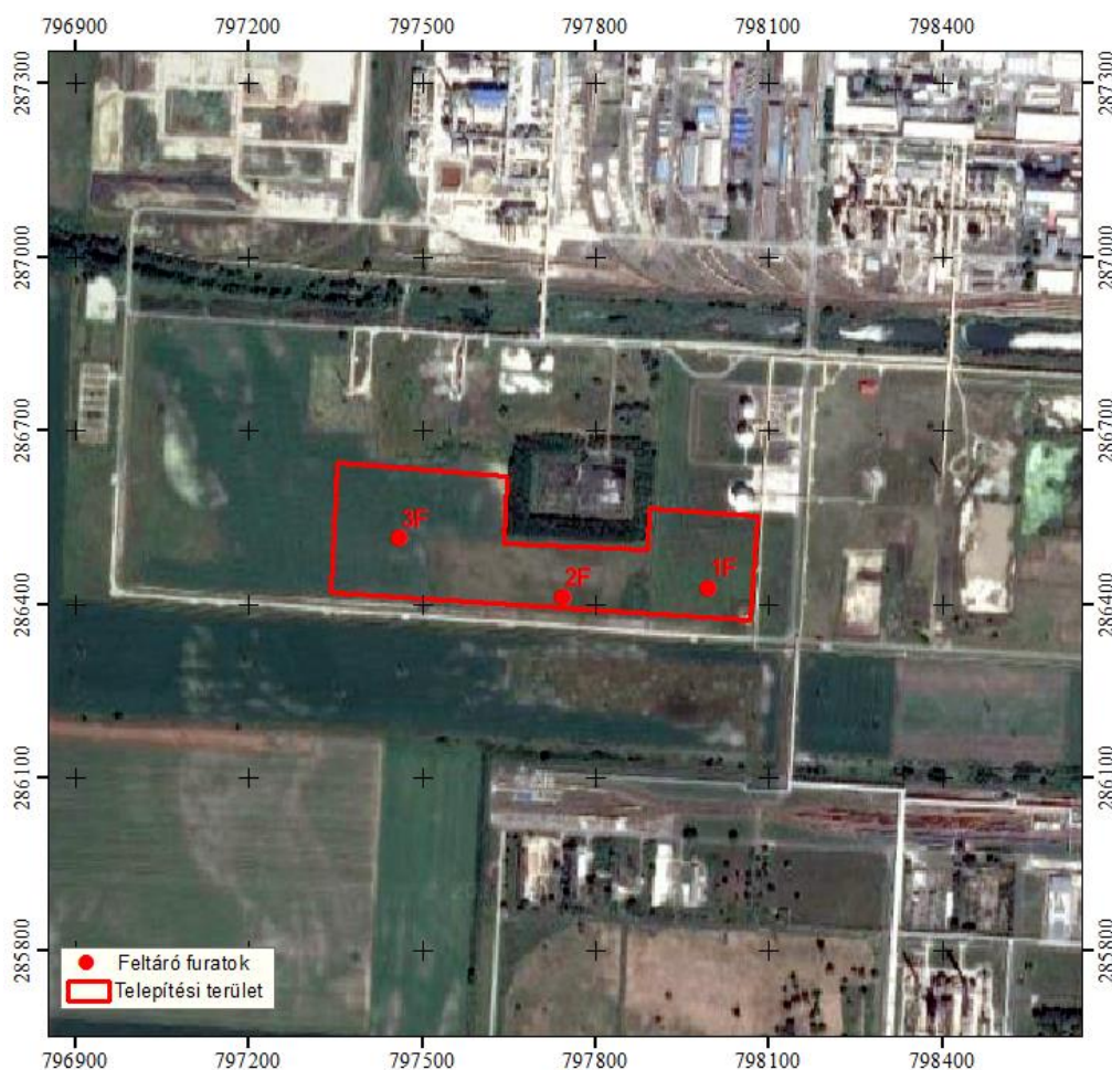
8-2. ábra. Talajfeltáró fúrások létesítése a telepítési területen
