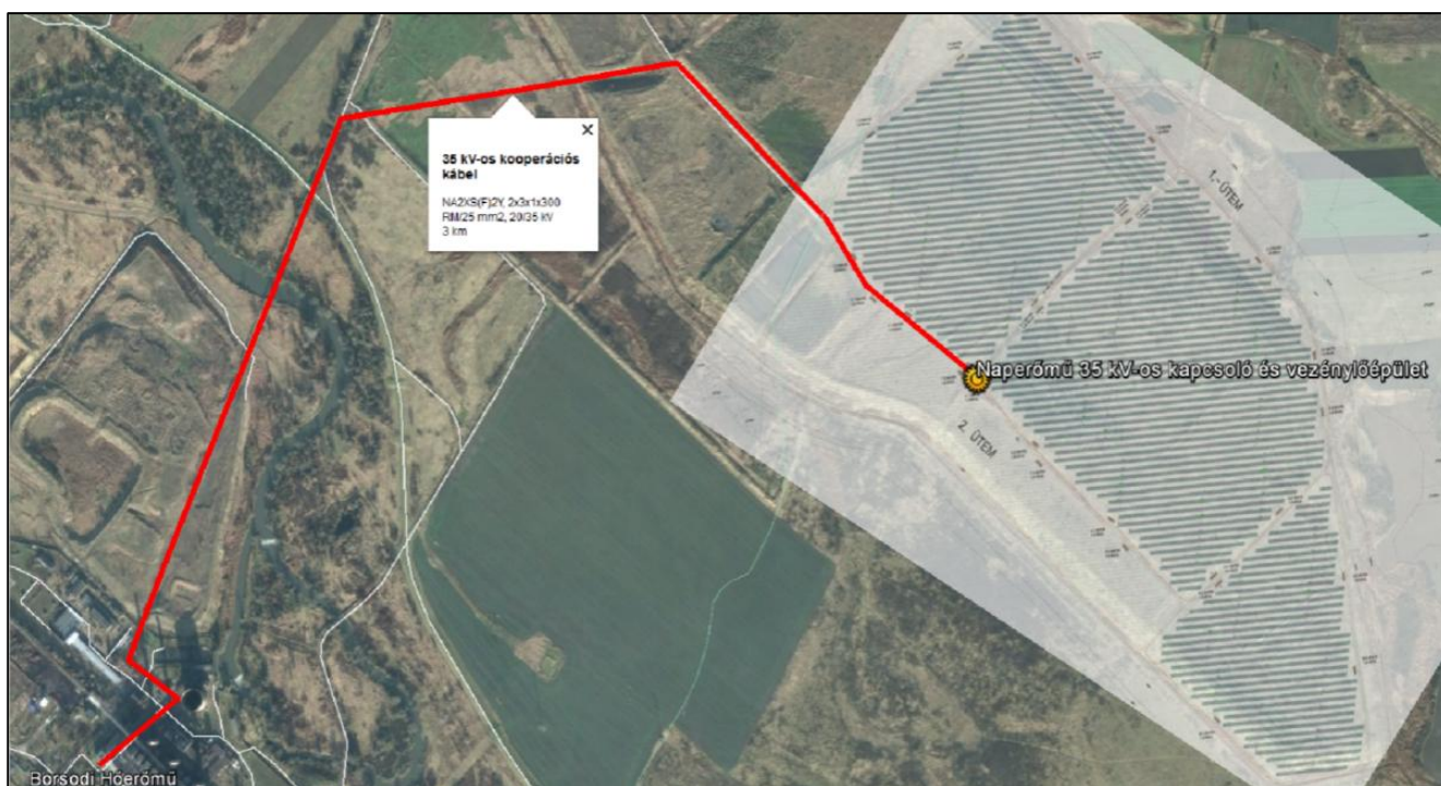
2.6.1. ábra: Az erőmű belső technológiai kábel lehetséges nyomvonala (forrás: Solar Center Kft.)
