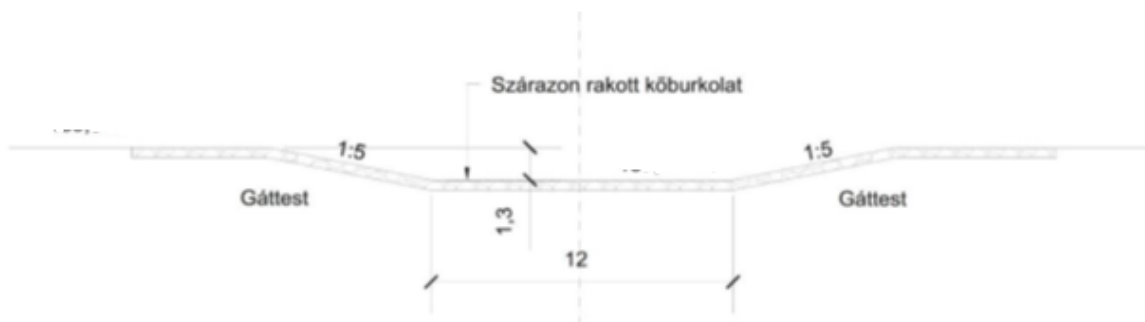
12. ábra: Homlokbukós vészárasztó elvi kialakítása
