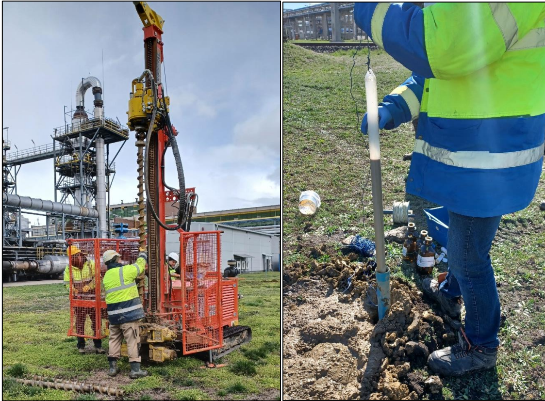
28. ábra: Mintavételi furat kialakítása (balra) és felszín alatti vízmintavétel (jobbra)
