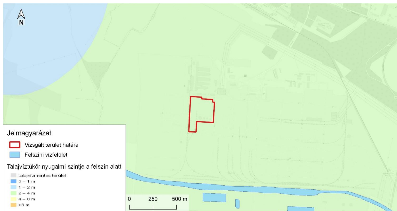
5. ábra: A vizsgált terület talajvízszint mélység térképen (MBFSZ)
